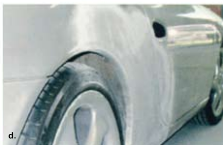
1. ábra: sérült kocsiszekrény egyengetése Miracle eszközökkel a – külső részre húzófülek felhegesztése, b – húzás kézi készülékkel, c – felső rész húzása, d – kijavított, kitelt felület
